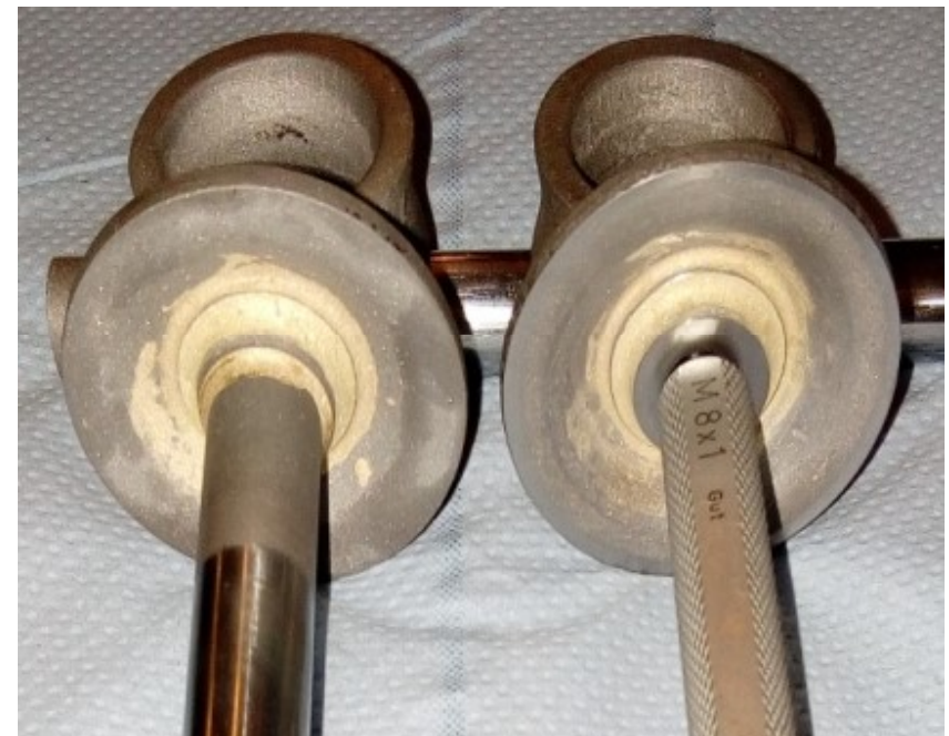
Linke Seite: alte Kolbenstange (KS) mit Verstärkungsring, rechte Seite KS abgestochen, Gewinde M8x1 für neue KS eingebracht.
