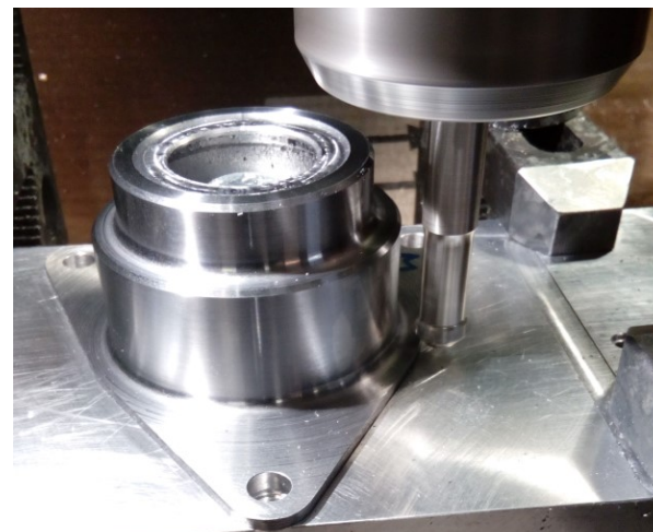
Rückseite außen Fase fräsen
