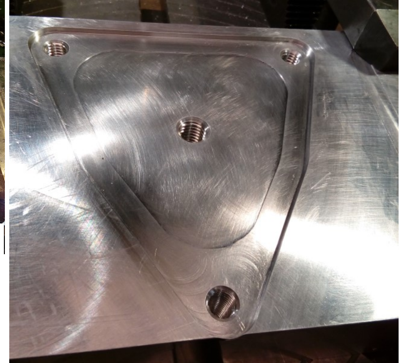
Werkstückaufnahme f. rückseitige Bearbeitung
