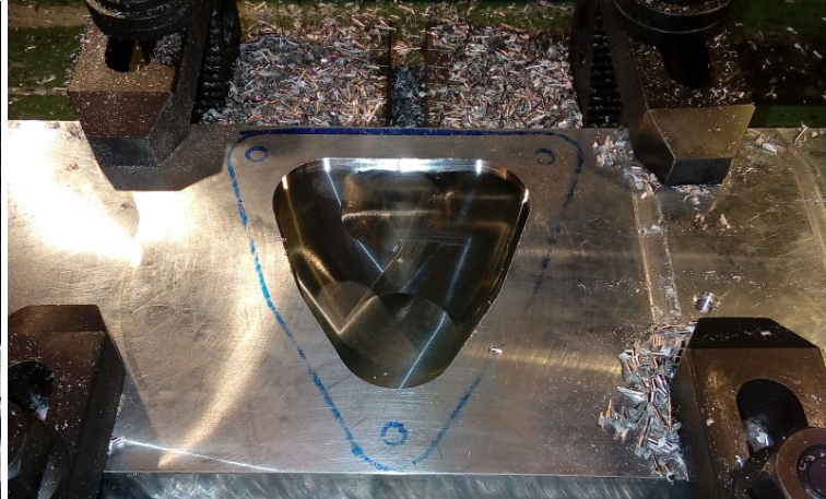
Werkstückaufnahme f. rückseitige Bearbeitung
